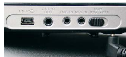
An der Unterseite befinden sich Mini-USB-Port, die Anschlüsse für Kopfhörer, TMC-Antenne und Mikrofon sowie der Hauptschalter
