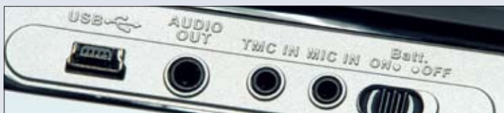
Über die TMC-Buchse erreichen den SNOOPER Verkehrsmeldungen.
